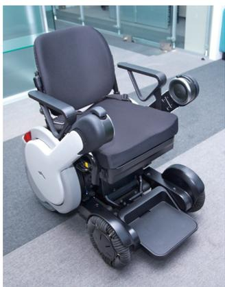
Model M 手柄頂端，可以像使用滑鼠一樣控制方向，針對手部力量較小的老人，還提供了一個好使力的抓手。
